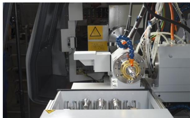
Beispiel für einen in die Maschine integrierten Werkzeugwechsler, mit dem auch spanende Bearbeitung und Messungen möglich sind.
