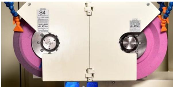
Пример узла для наружного и торцевого шлифования с одним прямым (цилиндрическим) шлифовальным кругом наружного шлифования, а также с одним двухсторонним профилированным шлифовальным кругом для наружного и торцевого шлифования (взаимного применения через круглый поворотный стол- ось V3).
