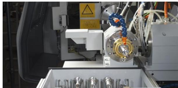
Пример устройства смены инструмента, встроенного в станок, с помощью которого можно выполнять обработку резанием и измерения.
