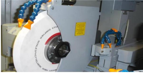
Пример шлифовального узла для наружного и торцевого шлифования, расположенного под углом 45° к оси заготовки, с двухсторонним шлифовальным профилированным кругом для наружного и торцевого шлифования
