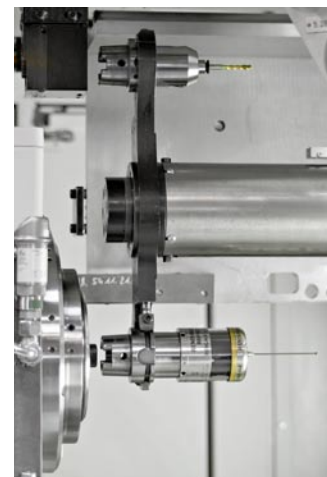
Beispiel für einen 52-fach Wechsler und den Wechselprozess zur Komplettbearbeitung komplexer Bauteile in nur einer Aufspannung
