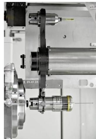
Beispiel für einen 52-fach Wechsler und den Wechselprozess zur Komplettbearbeitung komplexer Bauteile in nur einer Aufspannung
