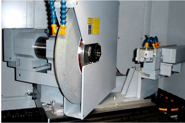
Beispiel für eine Außen- und Planschleifeinheit im Winkel von 45° zur Werkstückachse mit einer zweiseitig profilierten Außen- und Planschleifscheibe
