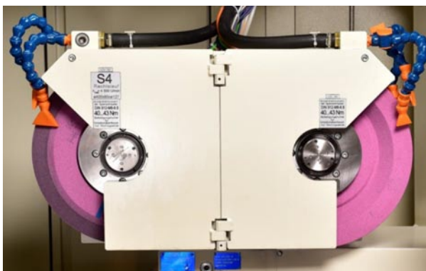
Beispiel für eine Außen- und Planschleifeinheit mit einer geraden (zylindrischen) Außenschleifscheibe sowie mit einer zweiseitig profilierten Außen- und Planschleifscheibe (wechselseitiger Einsatz über Rundtisch - B3- Achse).
