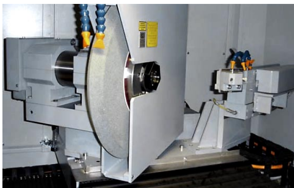
Пример узла для наружного и торцевого шлифования, расположенного под углом 45° к оси детали, с двухсторонним шлифовальным профилированным кругом для наружного и торцевого шлифования
