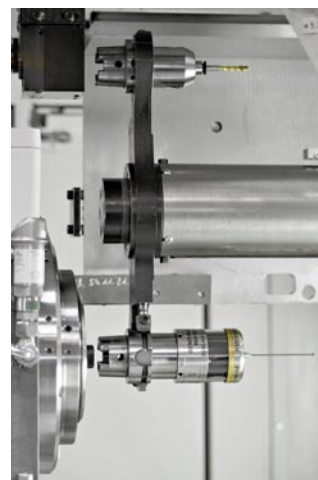
Пример устройства смены инструмента для 52-х позиций и процесса смены, для комплектной обработки сложных деталей только за один установ
