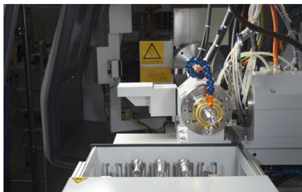
示例,集成在机器中的工具更换刀具等, 也可以进行加工和测量。
