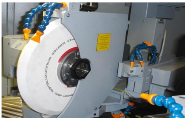
示例,外部和端面磨削单元与工件轴成 45° 角, 带有双面成型外磨砂轮和端面砂轮
