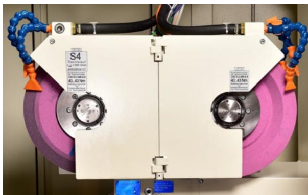
示例,外部和端面研磨单元的, 带有直 (圆柱形) 外磨砂轮和双面成型外磨砂轮和端面砂轮 (通过旋转台交替使用 – B3 轴)。
