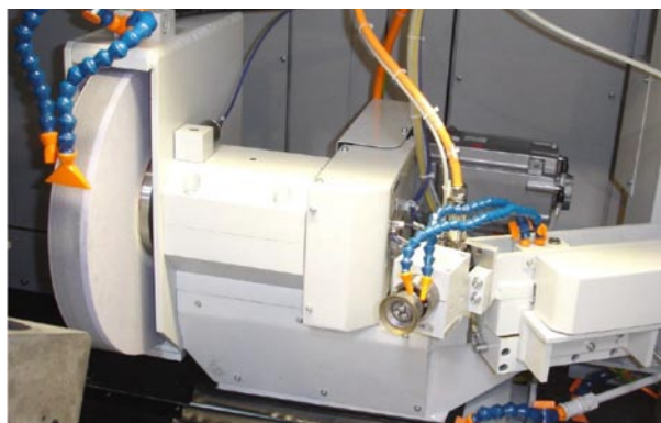
示例,外部和端面研磨单元与工件轴线 90° 角, 带有直 (圆柱形) 外磨砂轮
